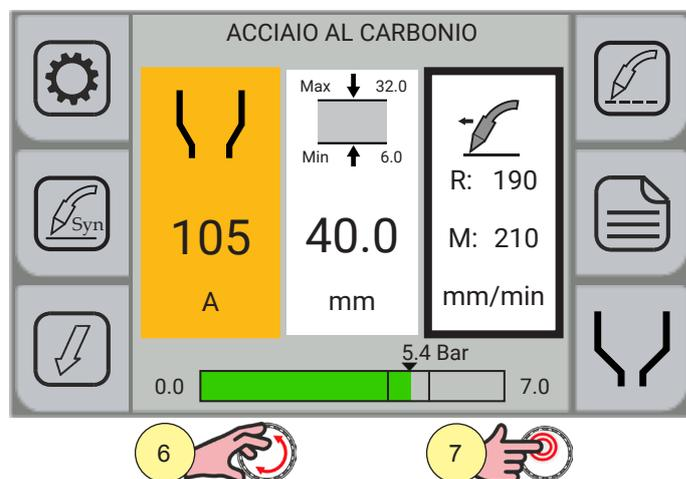
4. Selezionare il parametro "Corrente massima di taglio" toccando la relativa voce a display o ruotando l'encoder.
