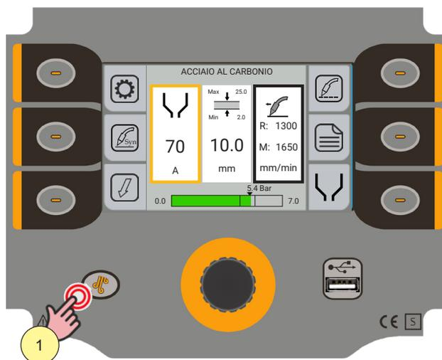
1. Aprire l'elettrovalvola del gas premendo e rilasciando il tasto (SOFFIAGGIO).
