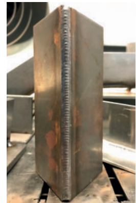
External edge PF welding
